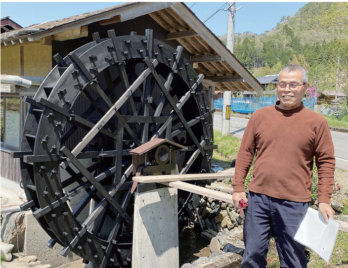
大工でもある上田会長が完成させた精米用の水車
